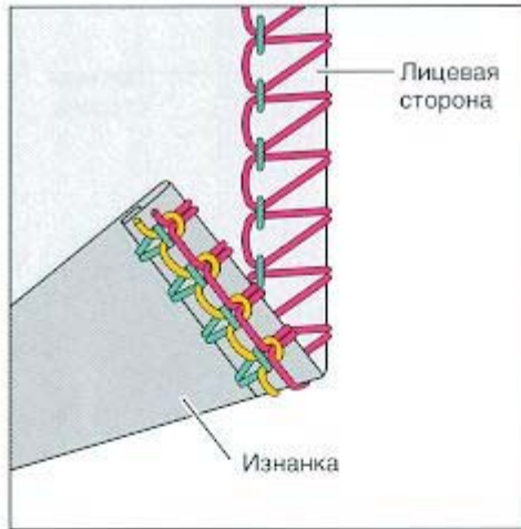
Слишком слабое натяжение правой игольной нитки (зеленой) . Установите зеленый регулятор на большее значение натяжения нитки.
